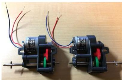
左側のモータのケーブルは長さが足りなくなるので、別途 20 cm の長いケーブルに付け替えてください。このとき、ケーブルの色はもともと付いていたケーブルと一致させるようにします。
