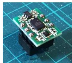
図 11：IC ソケットを利用して、ピン・ヘッドをはんだ付けする。
