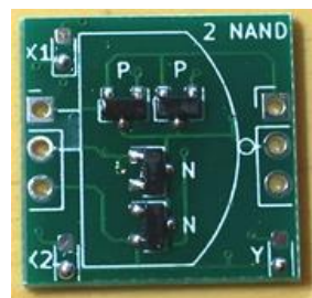
図 12： MOSFET をはんだ付けする。
