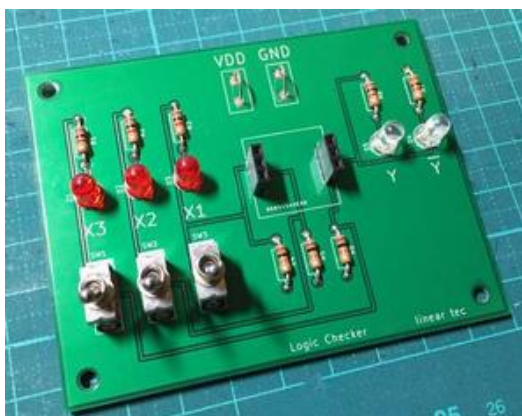
図10: 組み立てた「動作チェッカ」。
