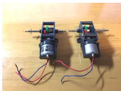
図28：ウォームギヤボックス HE を組み立てる。ギヤ比は 336:1 とする。
