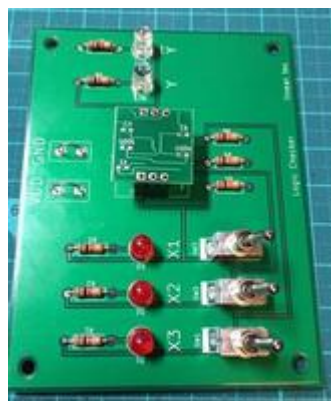
図16：「動作チェッカ」を基板固定用の治具として利用する。
